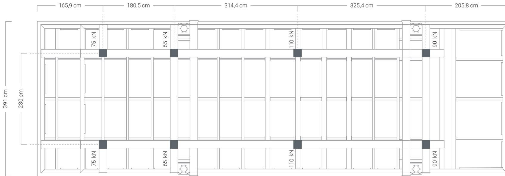
Berechnete Bodenlasten (einschließlich Schneelast  $S_{char} = 1,0 \text{ kN/m}^2$ )
